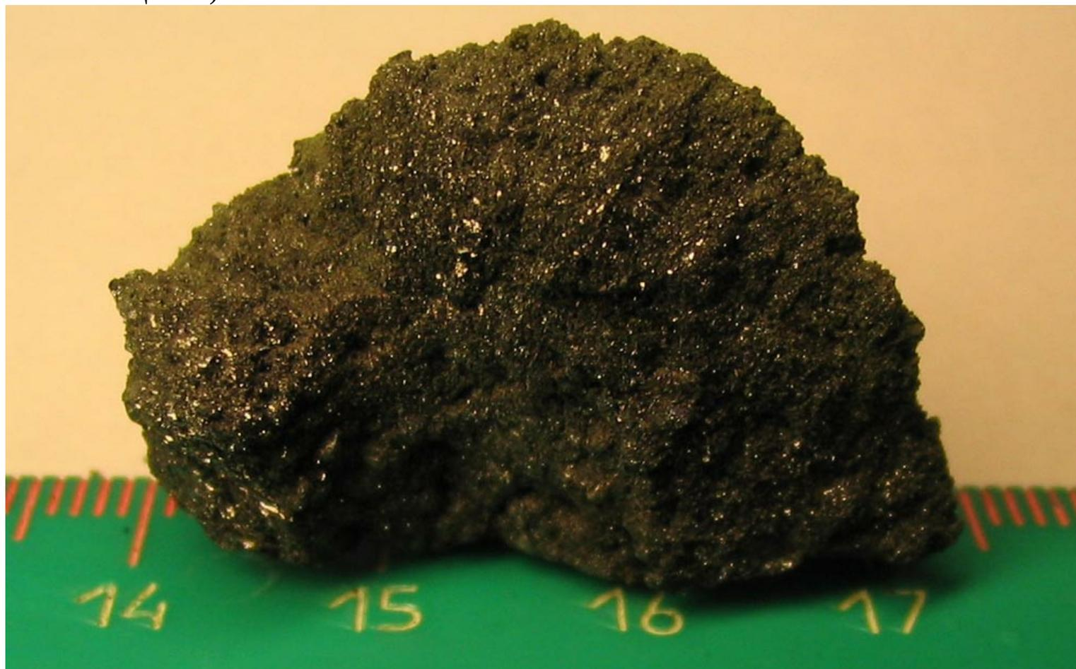
**Рис. 181.** Спек диоксида и карбида циркония
