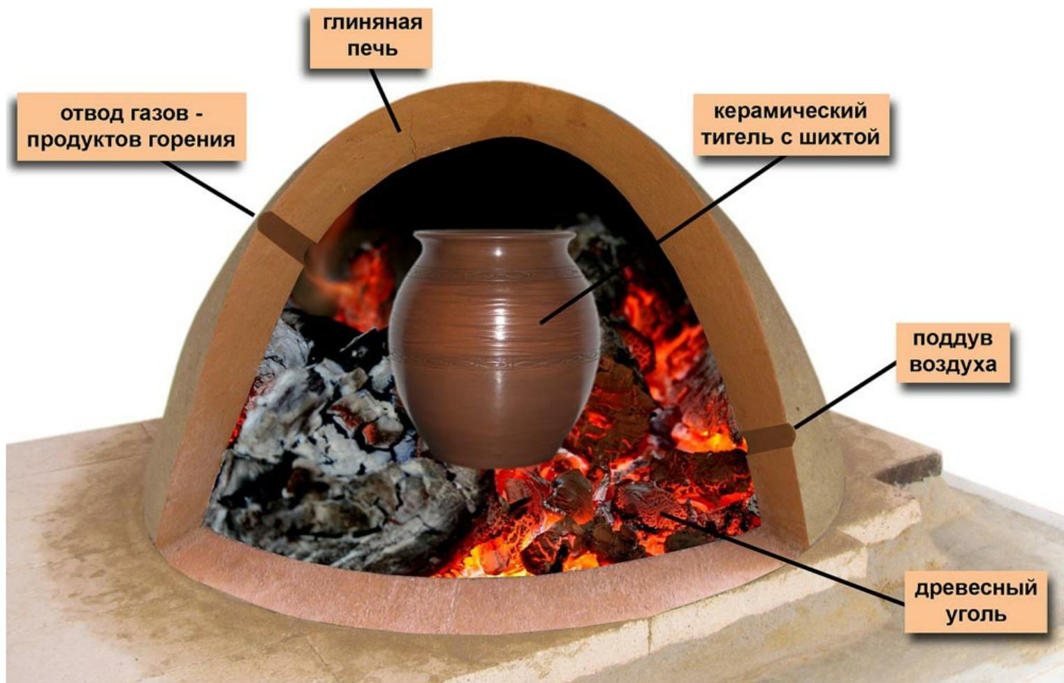
**Рис. 25.** Простейший горн для тигельной плавки
