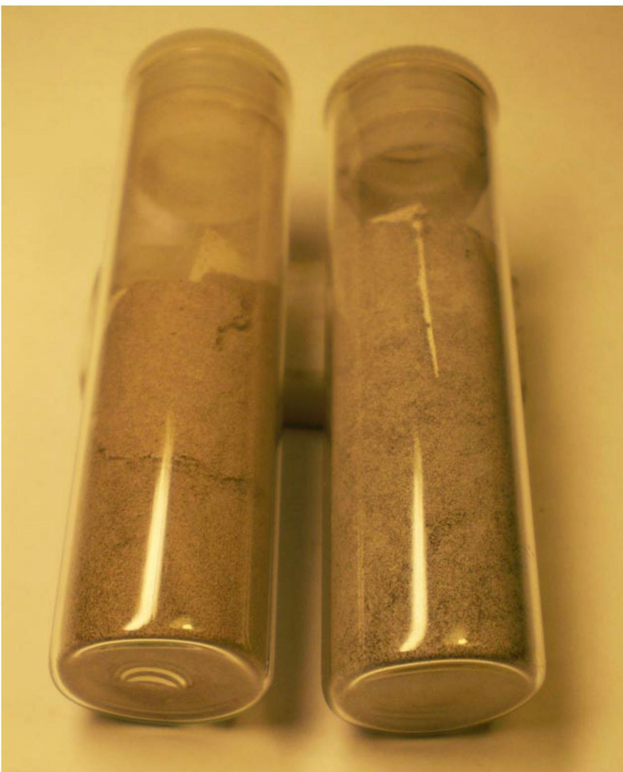
**Рис. 179.** Порошок металлического вольфрама, полученный из шеелитового концентрата
