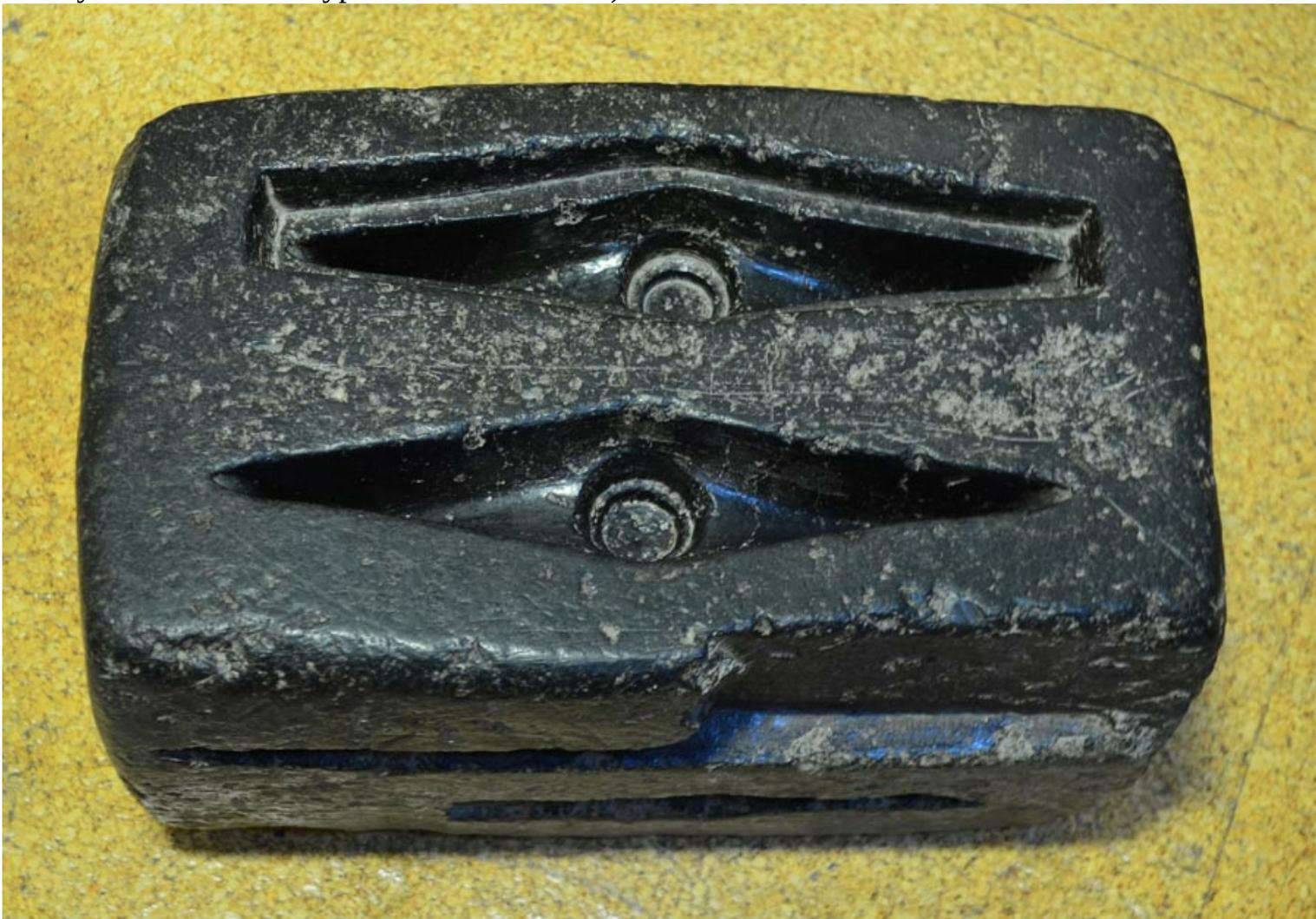
**Рис. 10.** Каменная форма для отливки топоров (Сардиния)
